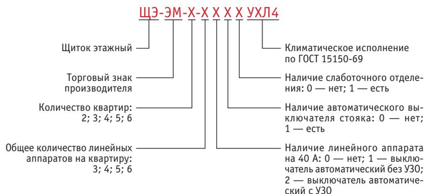
Пример записи для щитка ЩЭ-ЭМ на четыре квартиры, с тремя линейными аппаратами на квартиру, с автоматическим выключателем с УЗО, без автоматического выключателя стояка, со слаботочным отделением:
